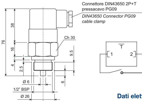
N.B.: Assemblare il termostato allo scambiatore con una rondella piana in rame.
