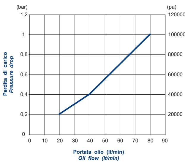
**CARATTERISTICHE TECNICHE DEL GRUPPO DI VENTILAZIONE**
