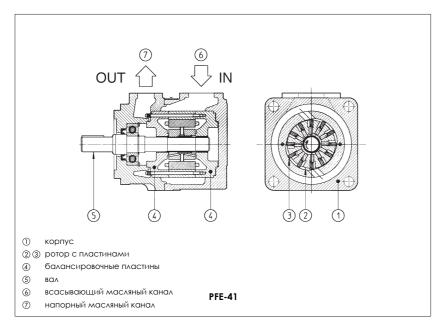
РFE - нерегулируемые пластинчатые насосы (число пластин - 12), картриджного исполнения (2) (3) со встроенным гидравлическим балансиром (4) для работы при высоком давлении и для увеличения сроков между сервисными обслуживании при низком уровне шума.
