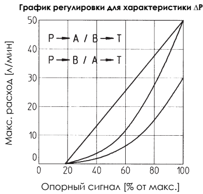
Как изменяется регулируемый расход клапана в зависимости от электрического опорного сигнала
