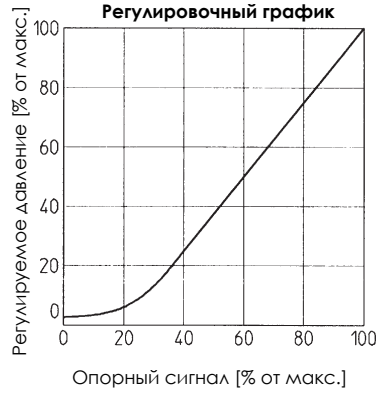
Как изменяется регулируемое давление клапана в зависимости от опорного сигнала.
