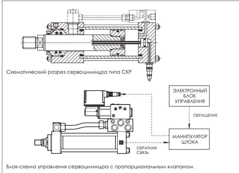
Электрогидравлические сервоцилиндры СК\* представляют собой исполнительные механизмы двойного действия с низкой степенью внутреннего трения, а также со встроенным электронным датчиком для противодействия положения штока.
