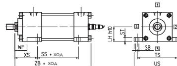
На лапах: E (ISO MS2) - Задний разъем по оси цилиндра
