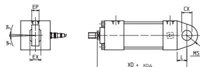
Шарнирное соединение: S (ISO MP5)
